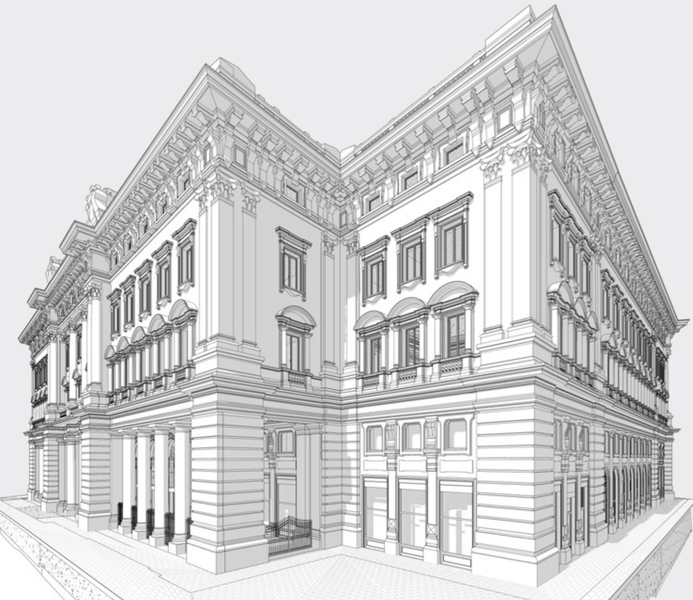
MODELLAZIONE BIM Restituzioni architettoniche e strutturali di dettaglio, Galleria A. Sordi - Roma Committente: Politecnica
